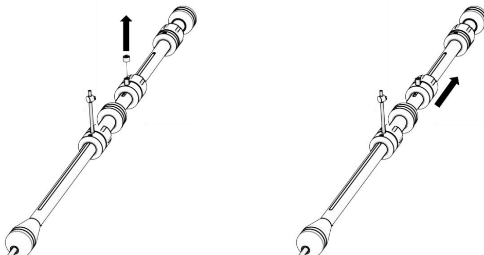
Figura 10: Destravamento do botão do fio trava e remoção completa deste.
